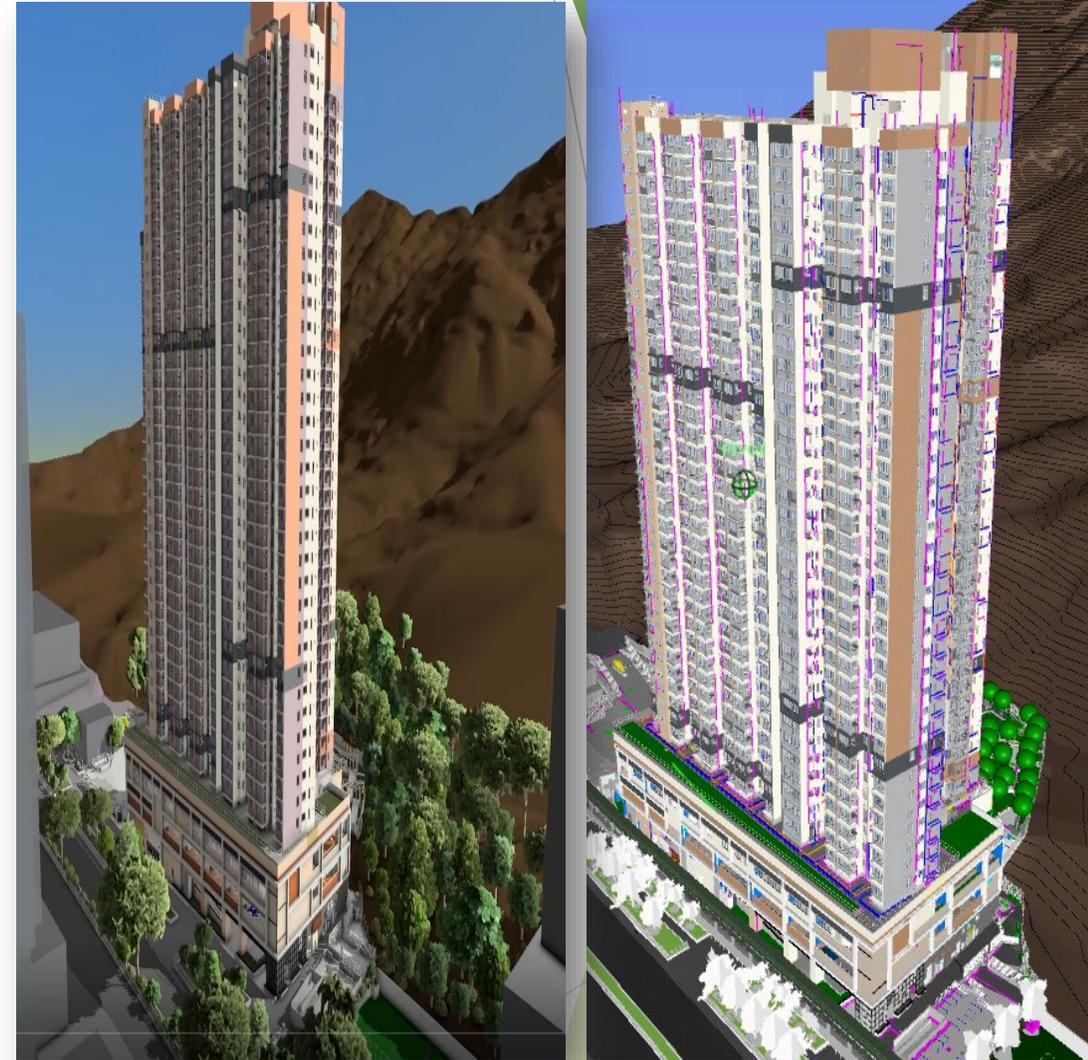
本地盤運用BIM建築資訊模型進行地盤建造模擬，模擬地盤一星期六天運作，物料來貨方式及建造方式，減低工程出錯及減低風險。
