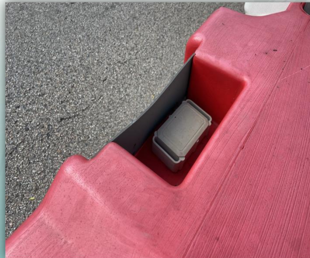
水馬撞擊感應器 (即時監測水馬有否被撞擊)
